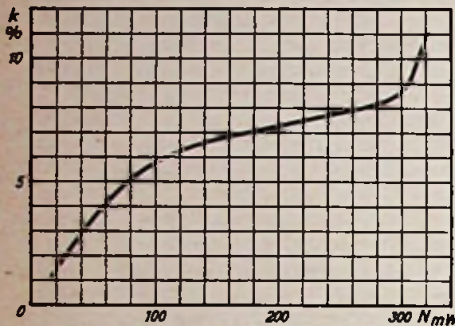
Bild 2. Klirrfaktor in Abhängigkeit von der Ausgangsleistung, gemessen bei 1800 Hz
