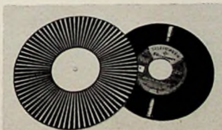
Bild 1. Stroboskopscheibe für 78 Umdr./min. neben einer handelsüblichen Schallplatte
